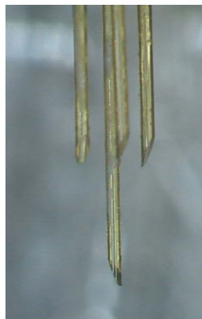
図4：4点光ファイバースローブ (F-TOP: Four-Tip Optical Fiber Probe) 材質：石英ファイバー、外形130μm
